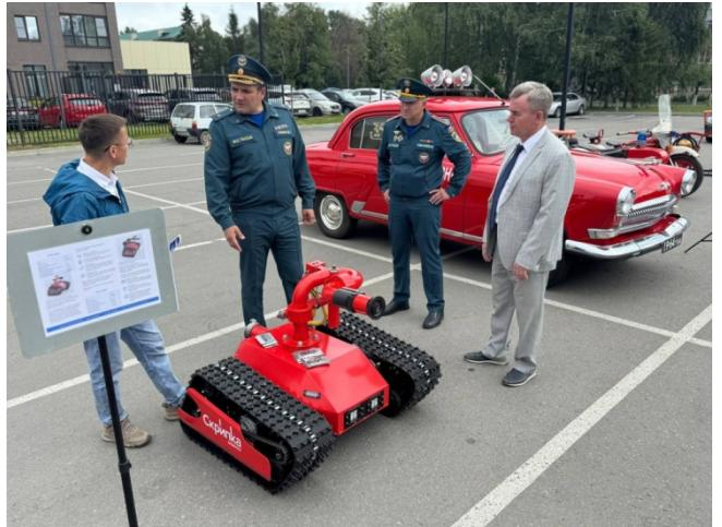
Техника передвигается на гусеничном ходу, компактна и удобна для ликвидации возгорания в труднодоступных местах. Такие роботы незаменимы при защите от огня складских комплексов, производственных помещений, в первую очередь - в нефтехимическом секторе, где есть риск выброса в атмосферу опасных веществ.
